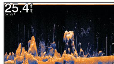
Traditionelle Geber senden einen konischen Kegel. Die Garmin ClearVü Scanning Echolottechnologie sendet zwei schmale Kegel, die dem Strahl in einem Kopiergerät ähneln. Diese Kegel produzieren ein klares, realitätsnahes Bild der Ansicht unter dem Schiff.
