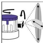
Variablen Sprühkopf auf Schadensgröße und Schadenslage einstellen.
